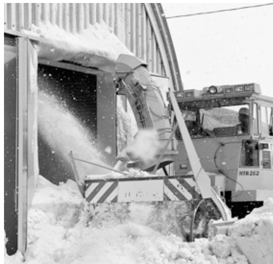
▲除雪車による給雪作業（本年3月）
