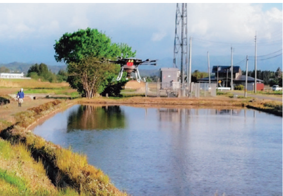
▲ドローンを用いた水田への播種の様子
